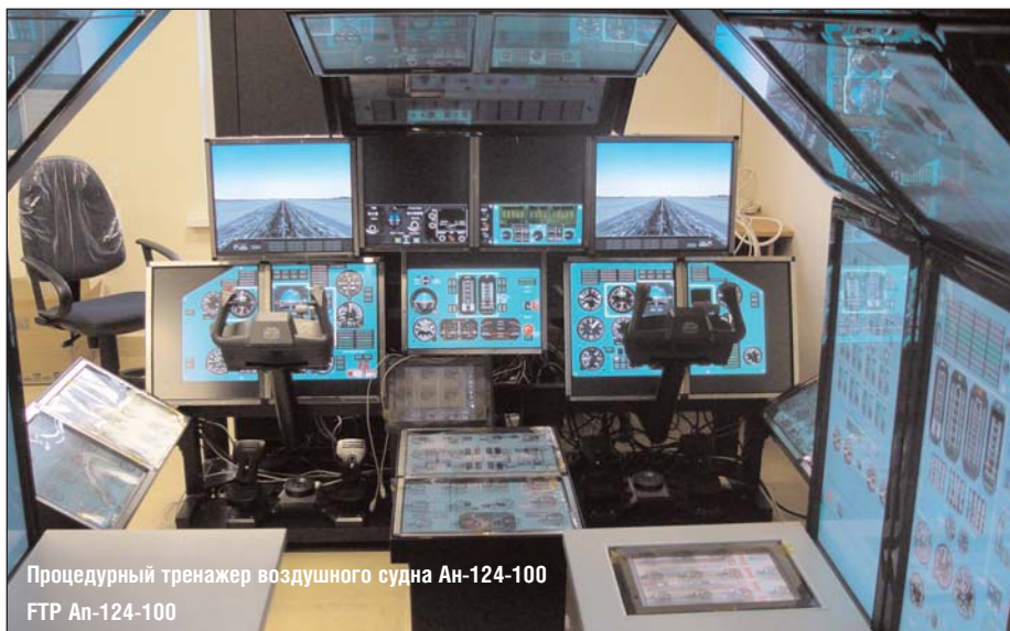
Полнопилотажный тренажер воздушного судна Ан-124-100 FFS An-124-100
